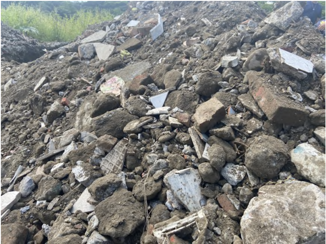
(照片 3：含零星廢棄物之營建混合廢棄物)
